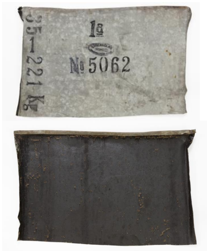
65. attēls. “Stokholm Galvaniseringsfabrik” jumta skārda loksnes 1920. gadi, 73 x 46 cm. Kalmāras lēnes muzejs, inv. nr. KLM046271
