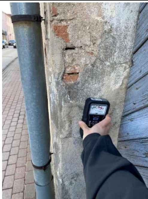
F - 34 Īpaši izteikts mitruma piesātinājums ār sienā novērojams ēkas ZR stūrī – zonā ap notekcauruli
