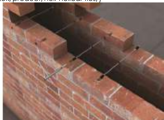
Ilustrācija 4 – tērauda saišu ar neoprēna uzdevām iebūves princips (Avots: https://www.ebmwales.co.uk/remedial-wall-ties-restraints/ )
