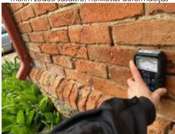
F - 45 Sienu lejas daļās daudzviet novērojams paaugstināts mitruma piesātinājums
