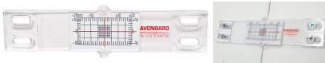
Ilustrācija 5 – plaknes lineāls AVONGARD TS21 plaisu monitoringam
