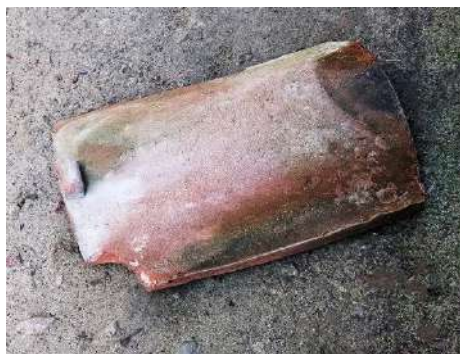
1. oriģinālais jumta seguma māla dakstiņš, māls, 35×23,2 cm, biezumu (izliekumā) 6,5 cm, 19. gs. beigas
