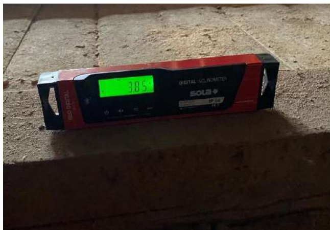
F - 38 Pārsegumam vairākās zonās novērojamas virsnormatīvas izlieces, slīpumi, kas sasniedz ~5 grādus
