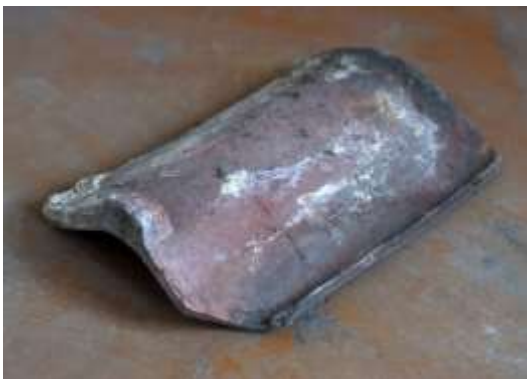
59. attēls. Viens no ēkas bēniņos atrastajiem, iespējams, sākotnējiem tās jumta seguma dakstiņiem. Dakstiņa izmērs – 33,5 x 22 cm
